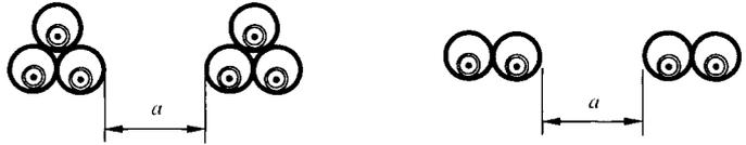
表 B.52.20 敷设在自由空气中多根多芯线缆束的降低系数
