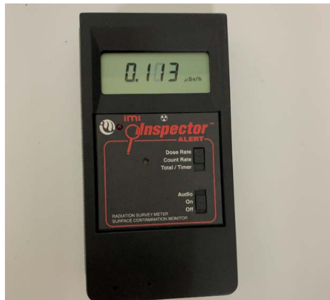
图 4-7 辐射监测报警仪实物图
