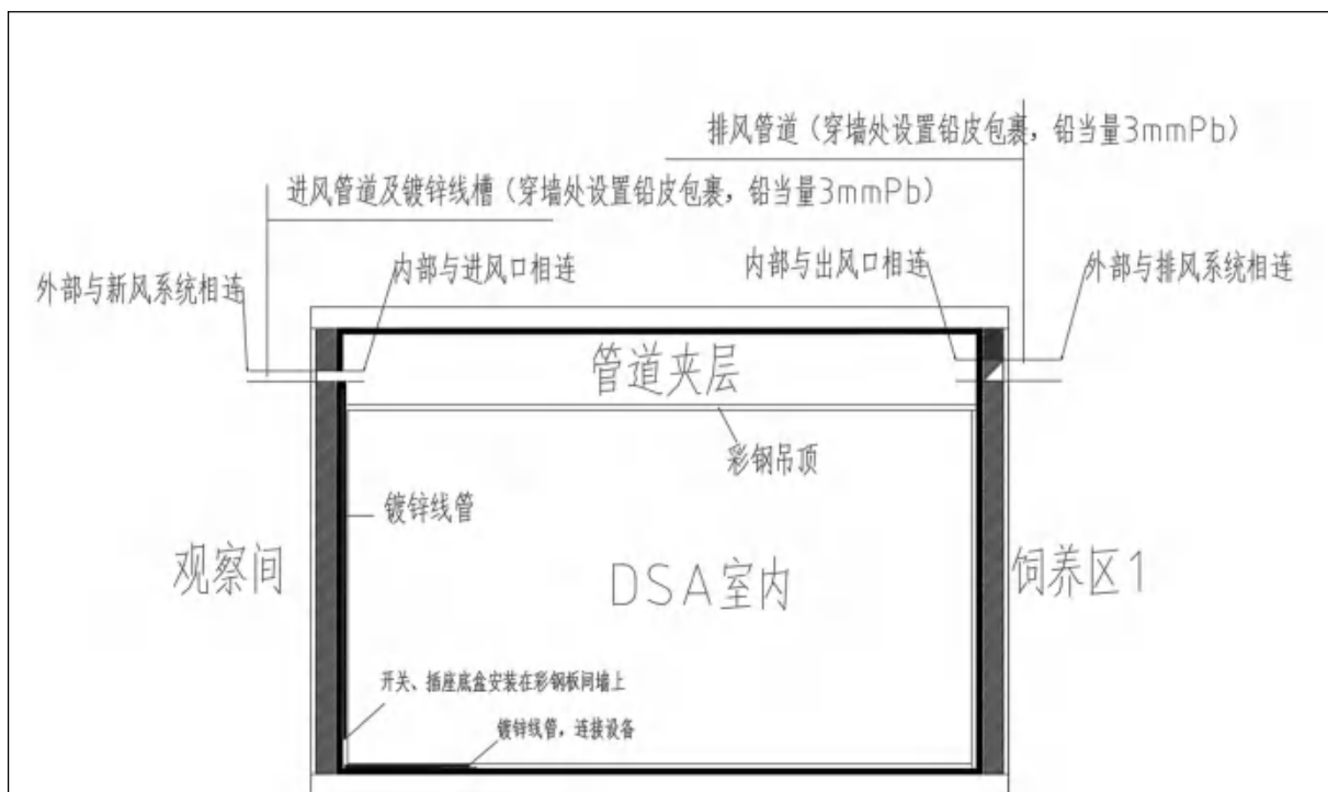
图 10-5 管线穿墙设计图
