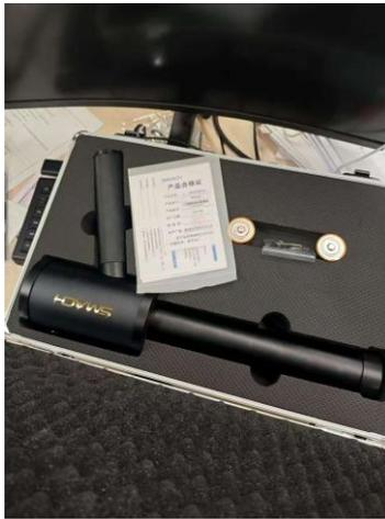
图 3-3.7 便携式 X-γ 剂量率仪
