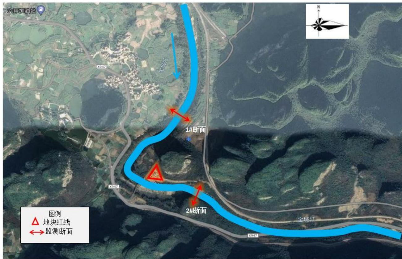
图 6-2 地表水监测断面平面示意图
