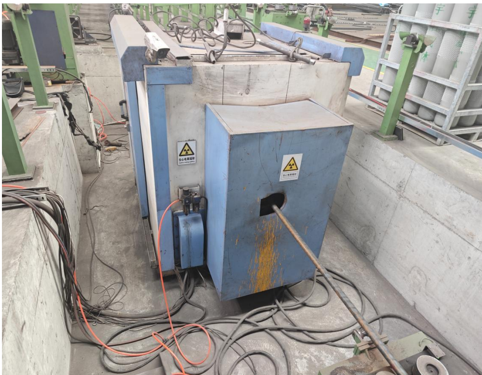
图 2-8 本项目 X 射线数字成像系统外观图
