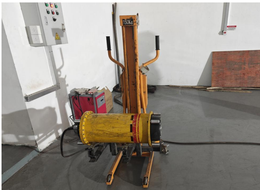
图 2-4 本项目周向探伤机外观示意图
