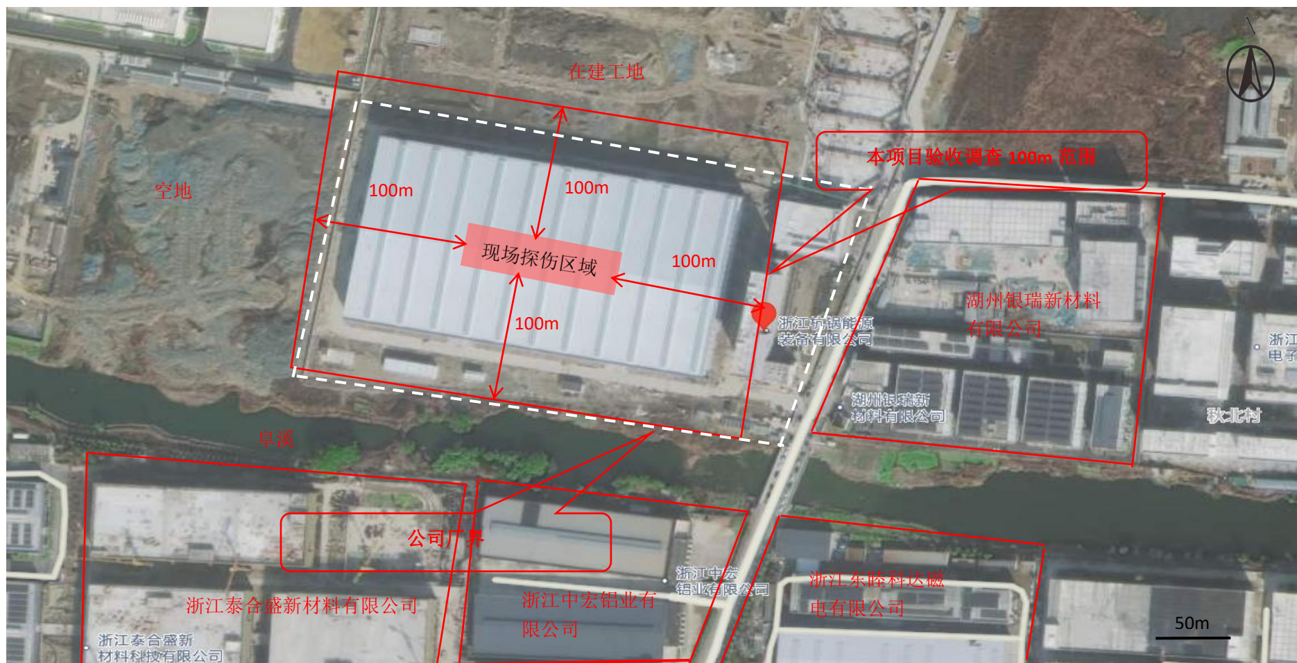
图 2-2 本项目现场探伤 100m 验收调查范围及公司周围环境状况示意图
