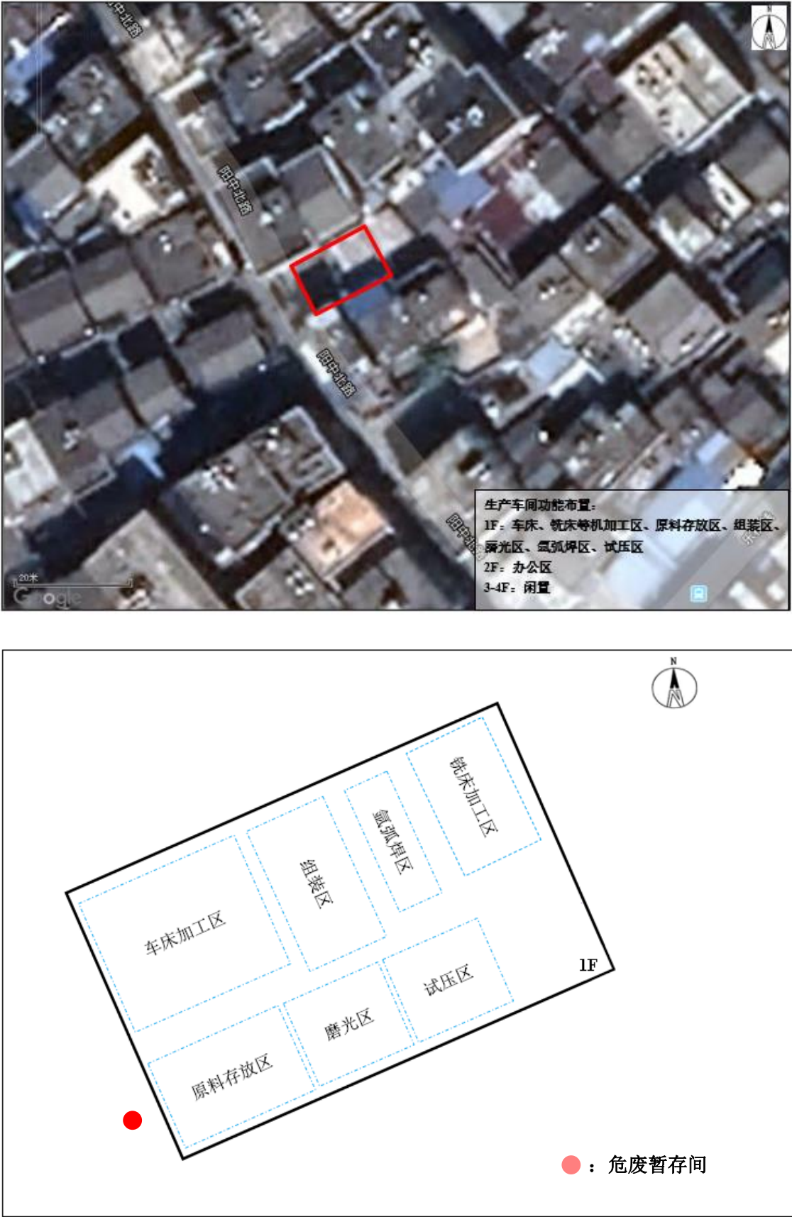
图 2-3 项目厂区及车间平面布置图
